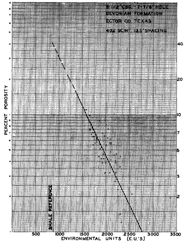
Fig. 8 NEUTRON DERIVED POROSITY CURVE
