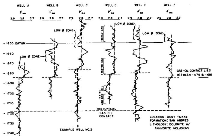
FIGURE 11—EAST-WEST CROSS SECTION SHOWING GAS-OIL CONTACT
