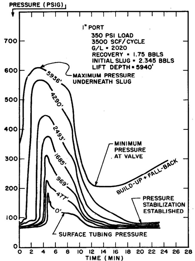
FIG. 12 TYPICAL PRESSURE RECORDINGS FOR 1" PORT.
