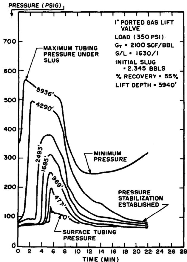
FIG. 14. TYPICAL PRESSURE RECORDINGS FOR A 1" PORT (MINIMUM GAS LIQUID RATIO).
