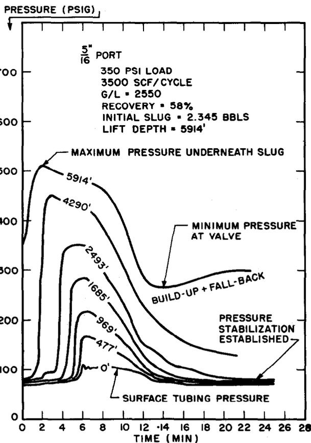
FIG. 13 TYPICAL PRESSURE RECORDINGS FOR 5/16 PORT.
