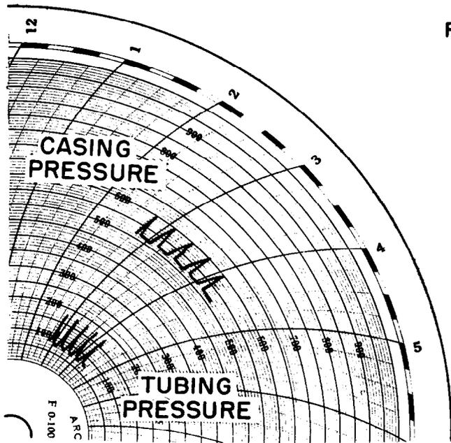
**FIG. 8. 24 HR REVOLUTION RECORDING CHART
