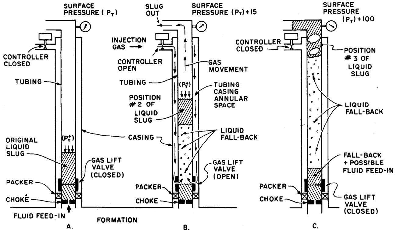
FIG. II. LIQUID SLUG POSITION.
