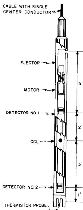
FIGURE 1 — THE RADIOACTIVE TRACER TOOL
