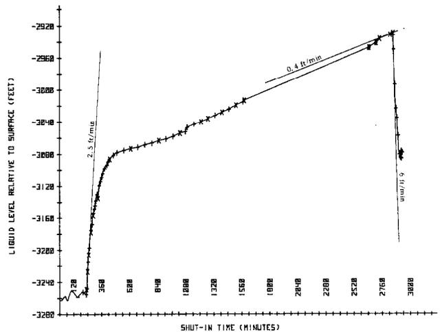
FIG. 19—LIQUID LEVEL VS SHUT-IN TIME
