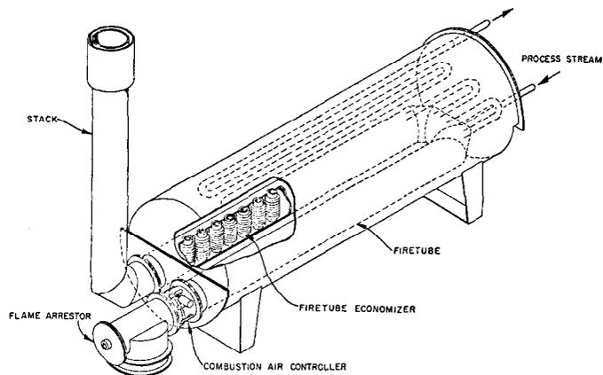
FIG. 4—TEST HEATER
