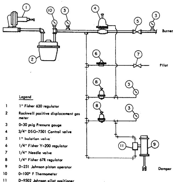
FIG. 5—FUEL GAS PIPING
