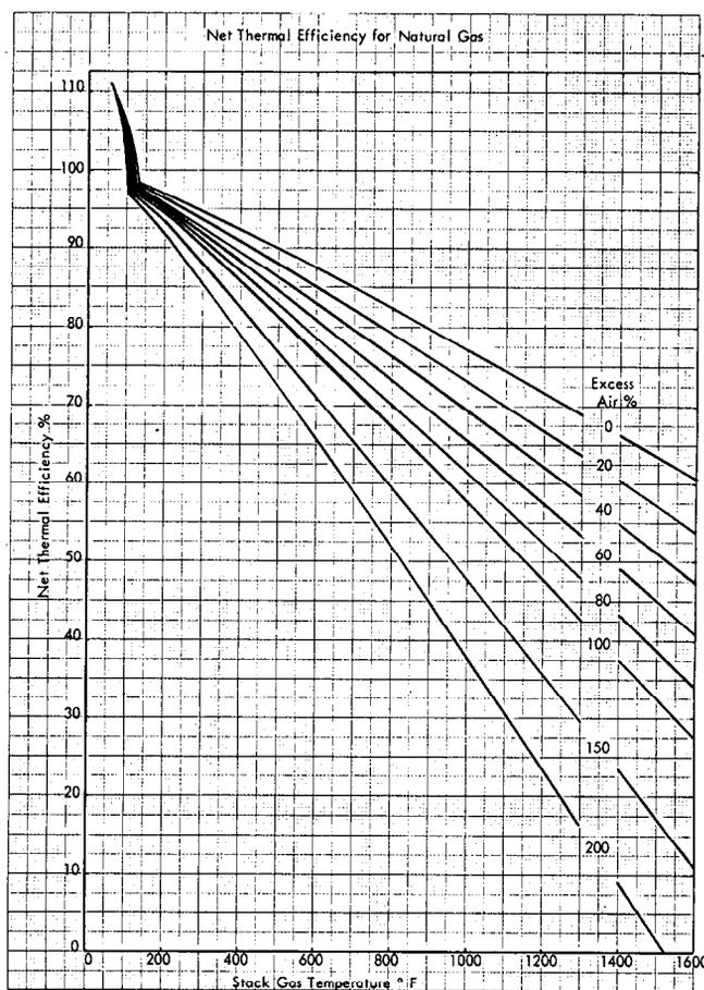
FIG. 1—NET THERMAL EFFICIENCY FOR NATURAL GAS
