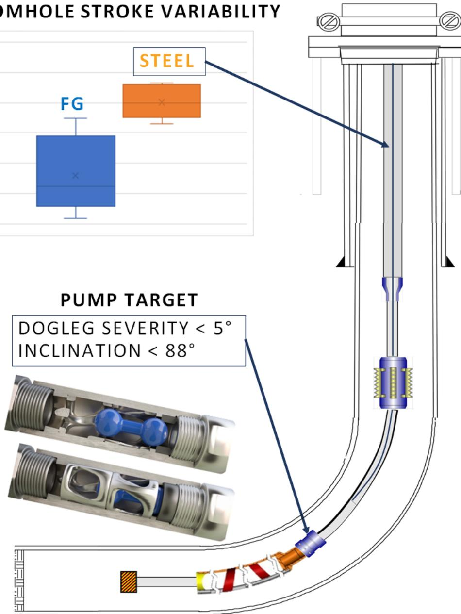
FIGURE 4 – HIGH ANGLE PUMPING SUCKER ROD AND PUMP DESIGN
