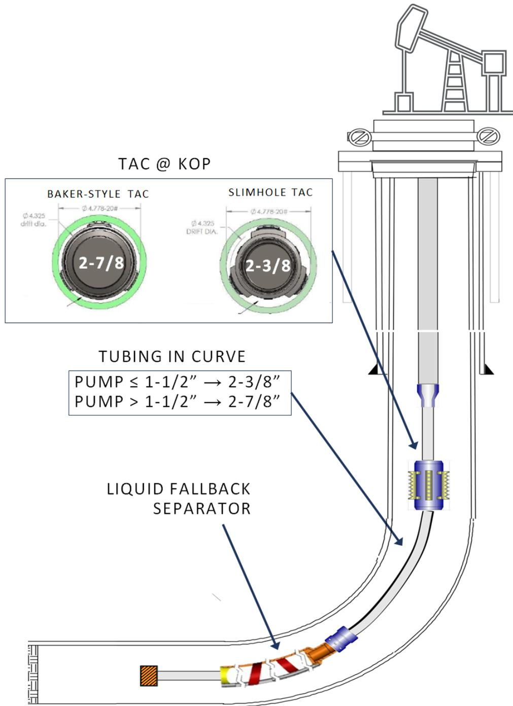
**FIGURE 16 – HIGH GAS SEPARATION EFFICIENCY DOWNHOLE DESIGN**
