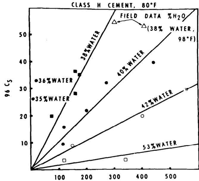
FIGURE 8—DEPENDENCE OF THE SLIP COEFFICIENT UPON THE CONSISTENCY INDEX,  $K'$ .
